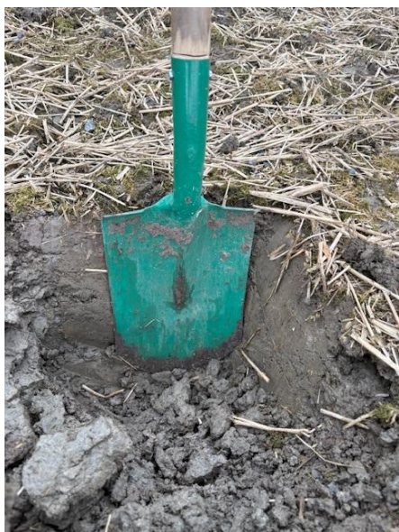
Figur 9: Prøvegraving viser 25-30 cm matjordlag i siltige og leirholdige masser
